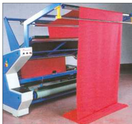
Alimentazione da falda - Plaited inlet
